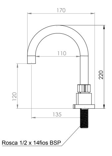
Mecanismo de vedação:1/4 volta Cano:Metal -3/4x 1.8 mm Canopla:Zamak Arejador:Fixo Dimensões em:Milímetros Peso Aproximado:
